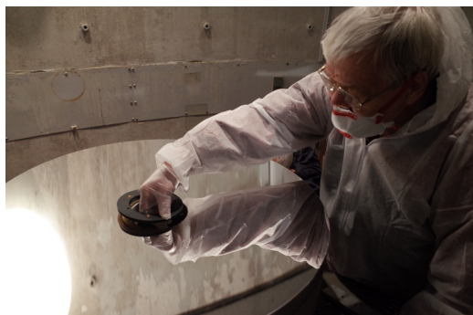
Figur 3: Knud Seifert indsætter centerfatningen efter, at spejlet er blevet re-aluminiseret. Foto: Michael Lindholm Nielsen
