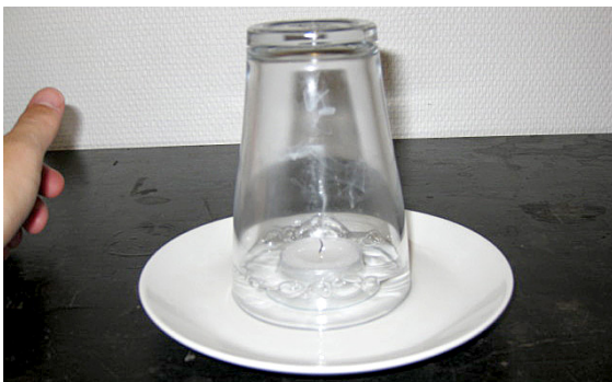
Figur 3. Efter få øjeblikke slukker lyset og noget af vandet suges ind i glasset.
