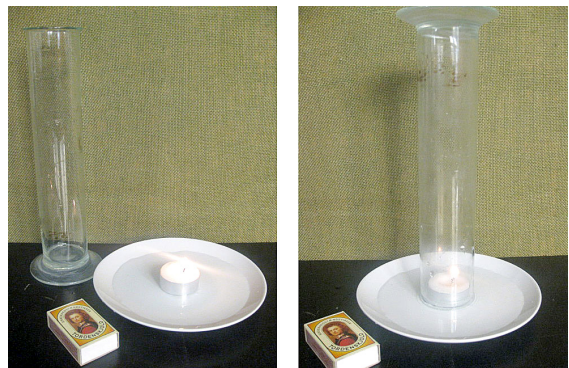
Figur 4. Til venstre: Tallerken med lidt vand og et tændt fyrfadslis samt en glaskolbe. Til højre: Glaskolben placeres over lyset.
