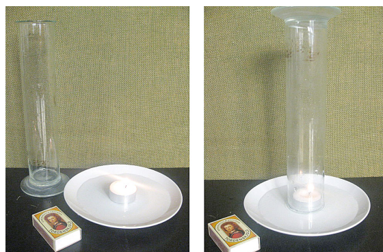
Figur 1. Til venstre: Tallerken med lidt vand og et tændt fyrfadslys samt et højt og slankt glas eller en glaskolbe. Til højre: Glasset placeres over lyset. Efter få øjeblikke slukker lyset og noget af vandet suges ind i glasset. Lyset kan hæves flere centimeter op fra tallerkenen. Med en buttet 2 liter glaskolbe er det nemt at få lyset til at hæve sig knap 10 centimeter (se senere).
