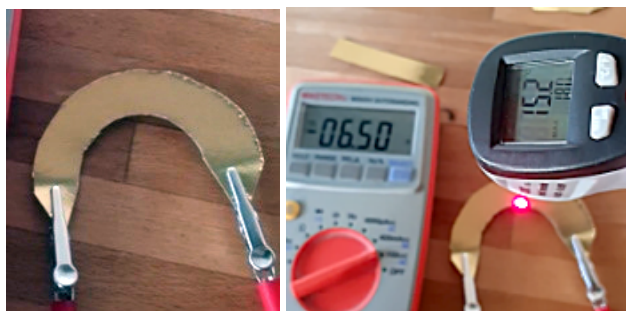
Figur 17. Skiveformet leder (t.v.) og opstilling med skiveformet leder, voltmeter og termometerpistol (t.h.).
