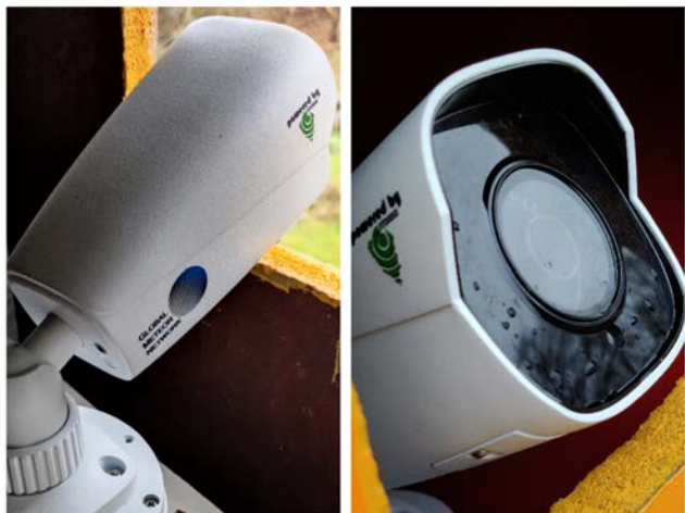
Figur 2. DK0001 titter ud af et afblændet vindue. Optikkens frie åbning, som kun anes, er ca. 3,8 millimeter.
