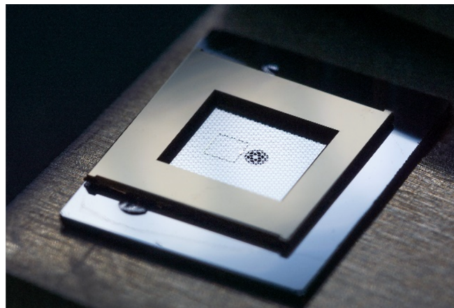
Figur 6. Venstre: En mikrochip med en membran, der kan bruges til at koble elektroniske qubits til fotoniske qubits Højre: Nærbillede af membranen, hvor der yderligere kan ses en kapacitor, der kobler til et elektronisk kredsløb (firkant) og en kavitet, der kan oscillere og koble til lys (cirkel).
